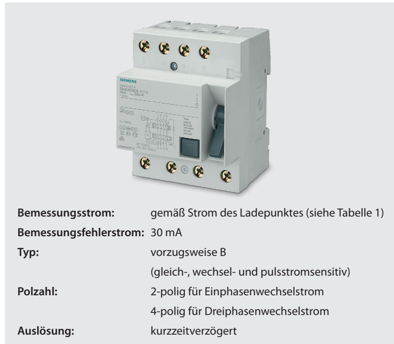
Bild 10: Fehlerstrom-Schutzschalter mit Kenndaten
